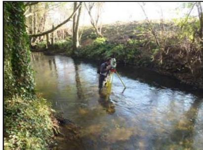
Sur 15 transects perpendiculaires à l'écoulement, les mesures et observations suivantes (espacement entre les points correspondant à 1/7ème du lit mouillé) sont réalisées :
